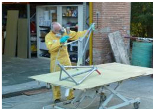
Application du chromate de zinc sur les trains.
