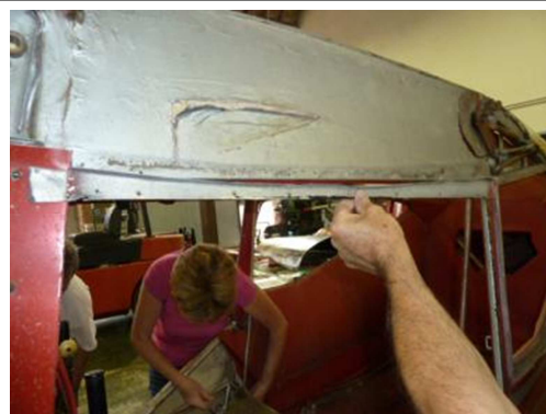
Déshabillage de l'intérieur de la cellule
